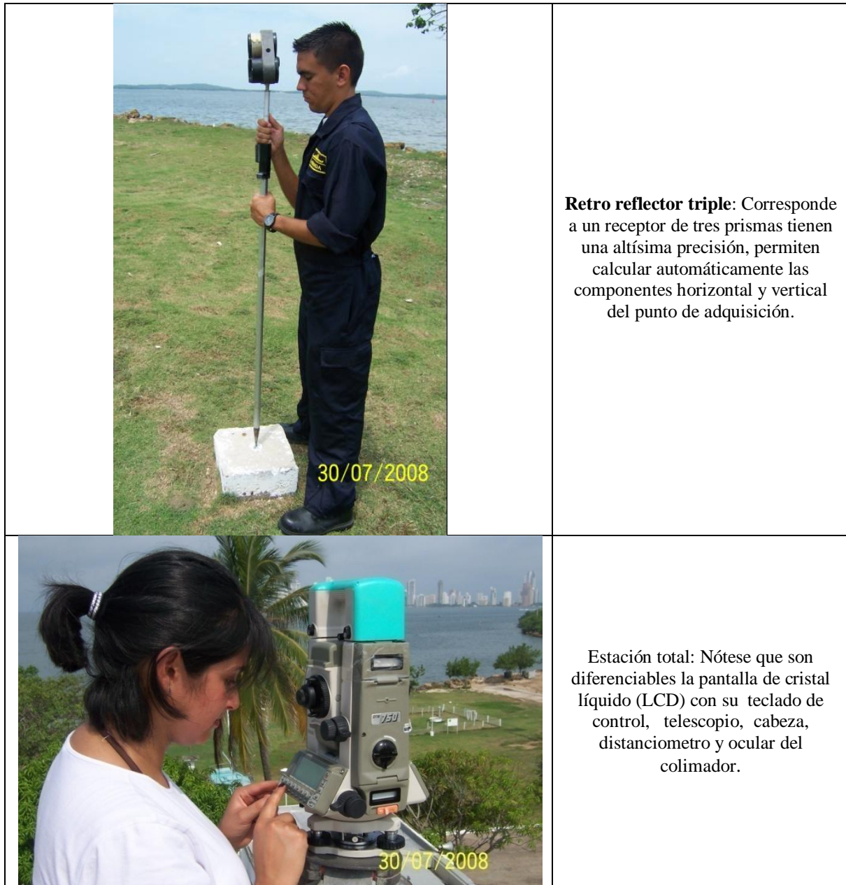
Figura 4.18. Trabajo de campo con la Estación Total
