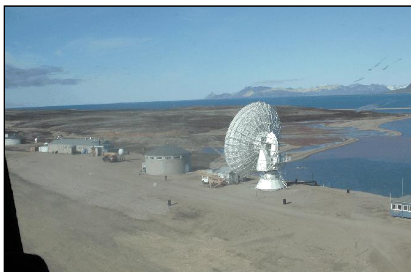
Figura 5.5 Ejemplo de una antena VLBI http://ivscc.gsfc.nasa.gov/publications/ar2003/nsnyal/
