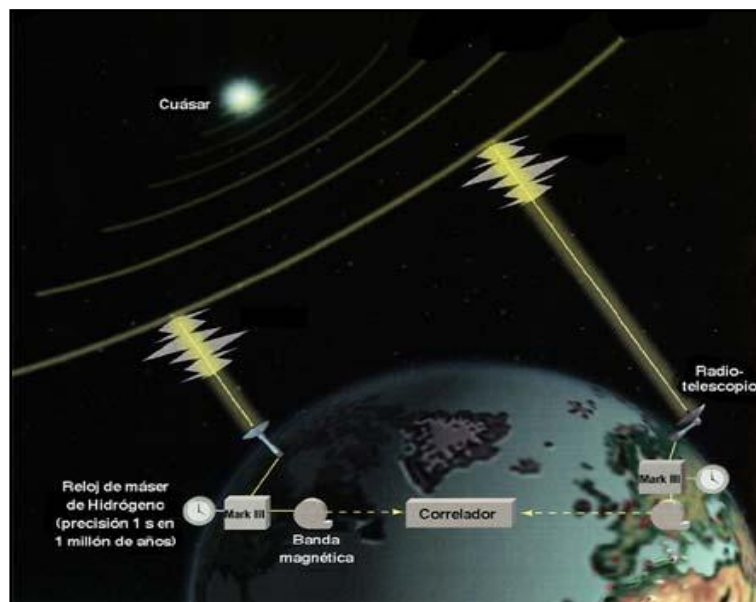
Figura 5.3. Esquema del funcionamiento de VLBI Tomada de: http://www.iers.org/
