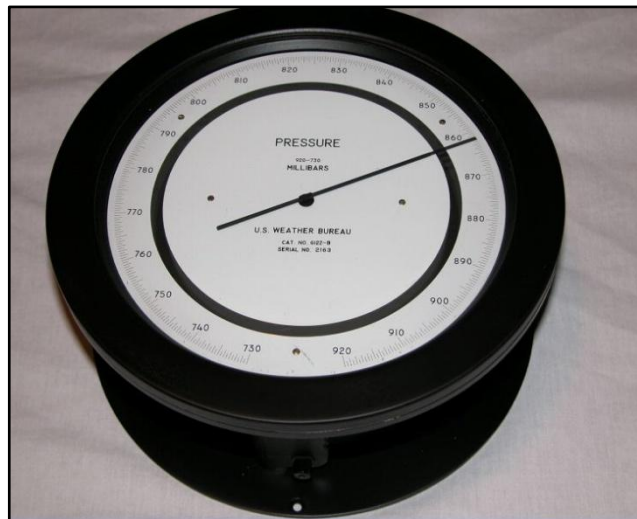
Figura 4.14. Barómetro: Weather Bureau 720 – 920 mb
