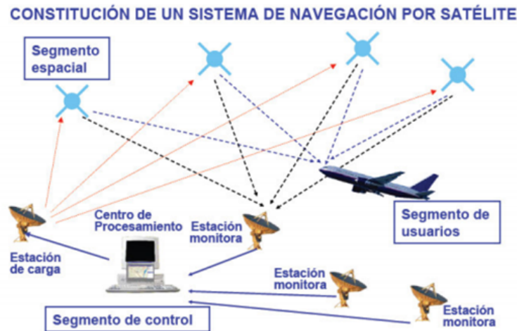
Figura 2-4: Funcionamiento de un GNSS. [Pérez Martínez, 2005]
