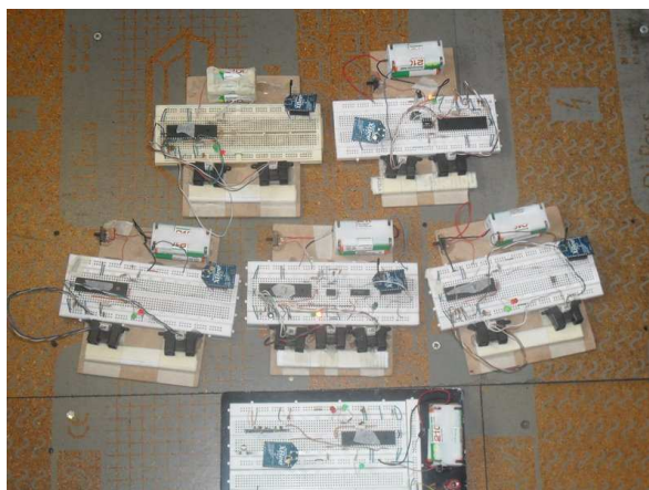
Gráfico 97. Implementación de los 5 módulos transmisores con los que se realizó la prueba piloto en el Museo Nacional.
