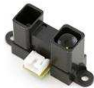
Gráfico 80. Sensor Sharp usado para medir la distancia.
