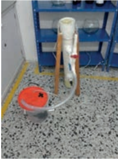
Figura 2. Reactor de oxidación química
