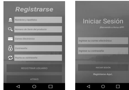
Figura 2 y 3. Interfaz que permite Registrarse (Izquierda) e Iniciar Sesión (Derecha) en el APP, para registrarse el usuario ingresa sus datos personales, y el número de serie del producto. Para iniciar sesión el usuario ingresa a la APP, digitando el correo electrónico y la contraseña.
