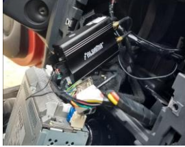
Figura 5. Dispositivo GPS Tracker instalado en el automóvil. Fuente: Elaboración propia.
