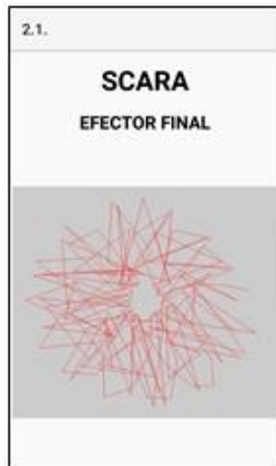
Figura 9. Gráfica en la pantalla del celular del movimiento en el plano x-y del efector final del robot SCARA.
