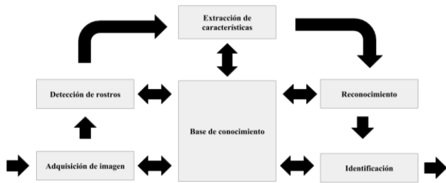
Figura 13. Diagrama de funcionamiento del sistema de RF
