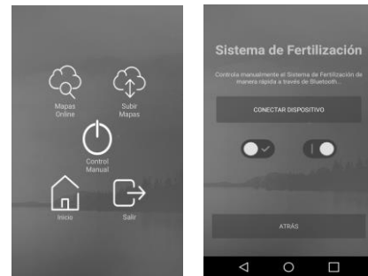
Figura 4 y 5. Menú del APP (Izquierda), el usuario a través de esta pantalla puede acceder a sus mapas online, subir los mapas, y el control manual del sistema de fertilización. La Interfaz que permite el Control del Sistema de fertilización (Derecha), el usuario conecta los dispositivos mediante bluetooth y tiene la posibilidad de control manualmente el sistema (Activar/Desactivar).
