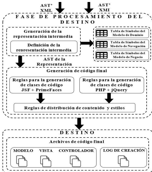
Figura 4. Arquitectura del generador de Aplicaciones Enriquecidas de Internet, fase del procesamiento del destino.
