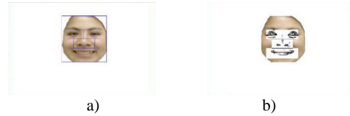
Figura 8. Detección de los bordes en partes del rostro. a) Imagen entrada, b) Imagen resultado de la detección de bordes en cada una de las partes del rostro.
