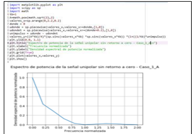
Figura 5. Figura 3. Densidad espectral de potencia de una señal unipolar sin retorno a cero
