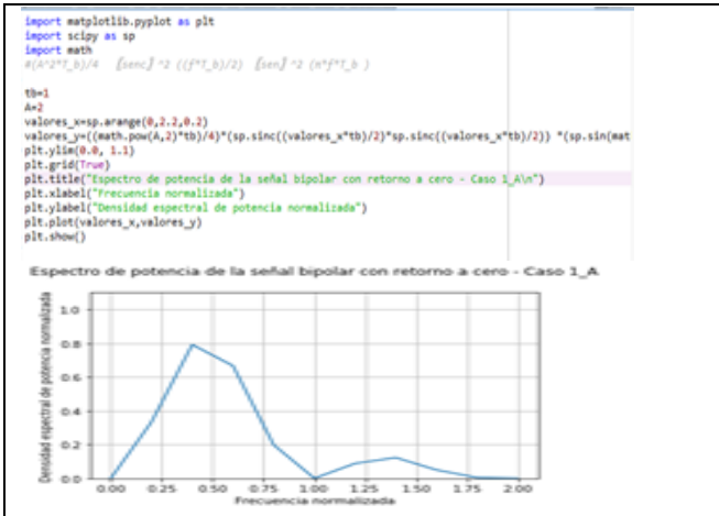
Figura 6. Figura 4. Densidad espectral de potencia de la señal bipolar con retorno a cero
