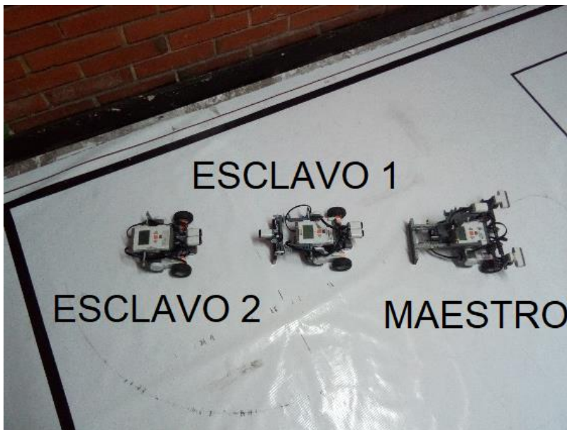
Figura 15. Formación en convoy dentro de entorno controlado. (fuente de elaboración propia)
