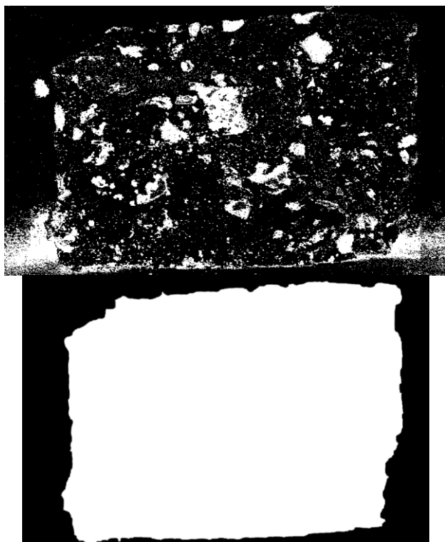
Figura 10. Binarización del agregado y del fondo
