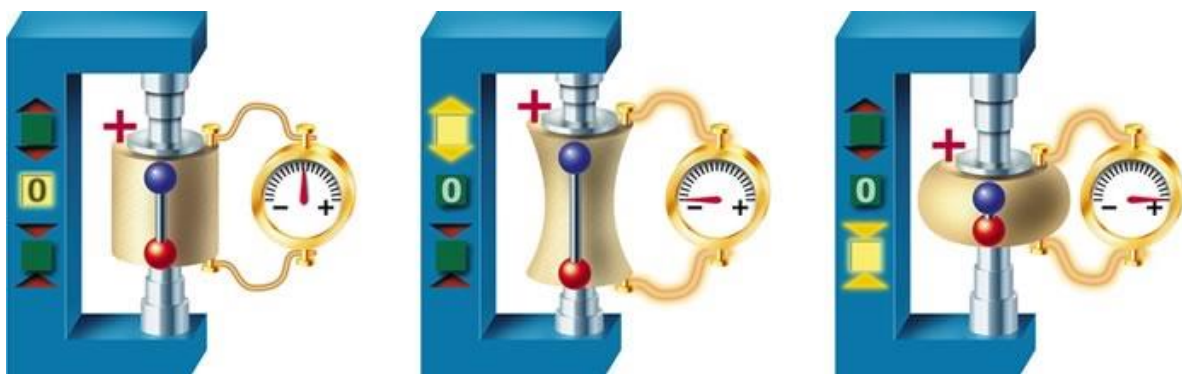
Figura 1. Efecto piezoeléctrico esquemáticamente.
