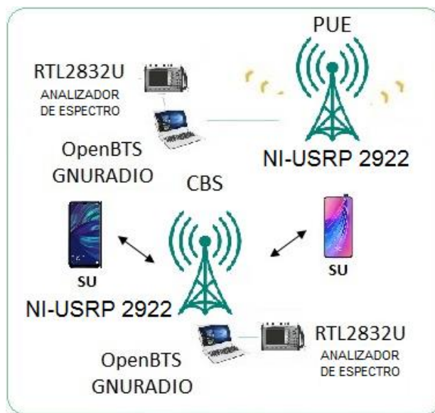
Figura 18. Esquema utilizado para experimentos.
