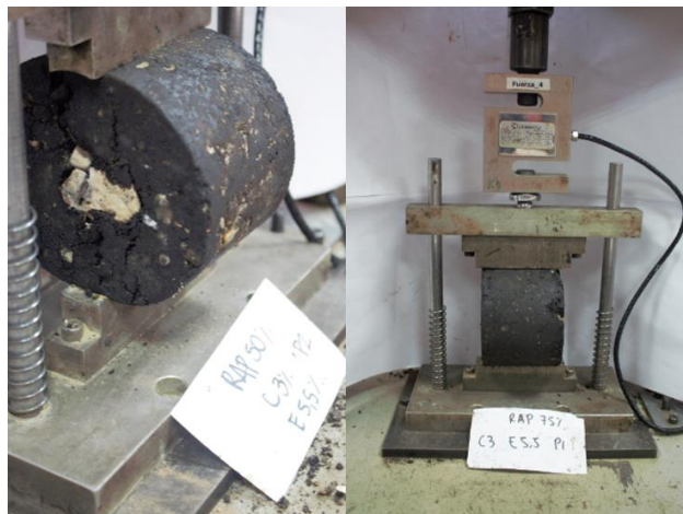
Figura 4. Ensayo a la tracción indirecta.
