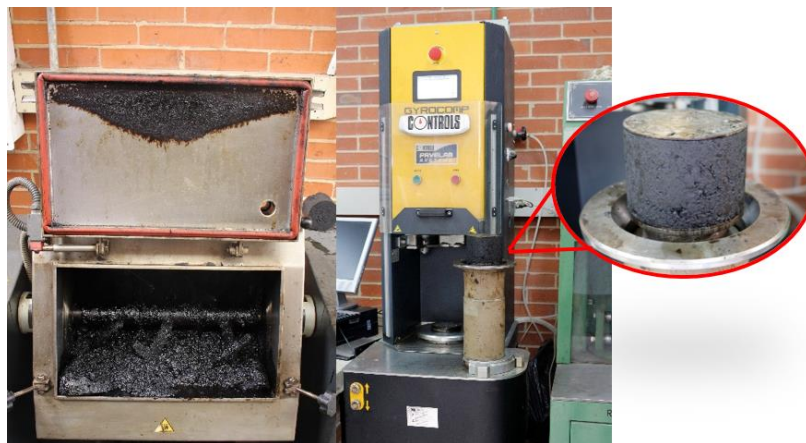
Figura 3. Fabricación de muestras asfálticas.
