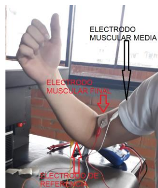
Figura 3. Posición de los electrodos en la recepción de la señal EMG. Fuente: elaboración propia de los autores.
