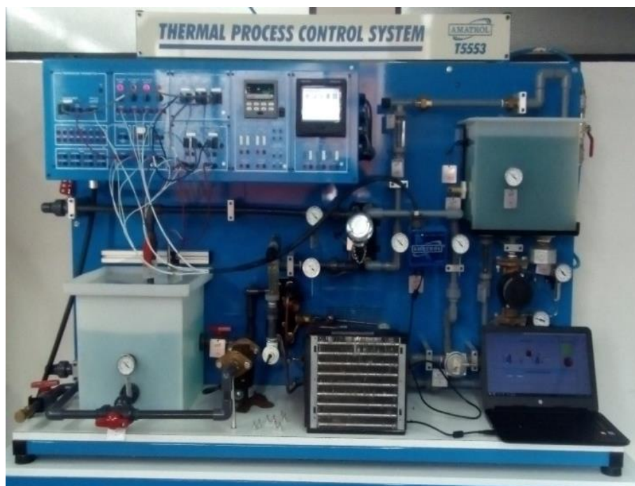
Figura 4. Sistema de monitorización de la planta térmica. Fuente: elaboración propia.
