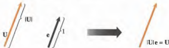
Figura 2.9 Como \mathbf{U} y \mathbf{e} tienen la misma dirección, el vector \mathbf{U} es igual al producto de su magnitud y \mathbf{e} .
