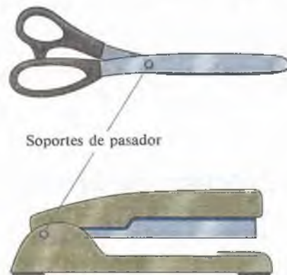
Figura 5.4 Soportes de pasador en una tijera y en una engrapadora.
