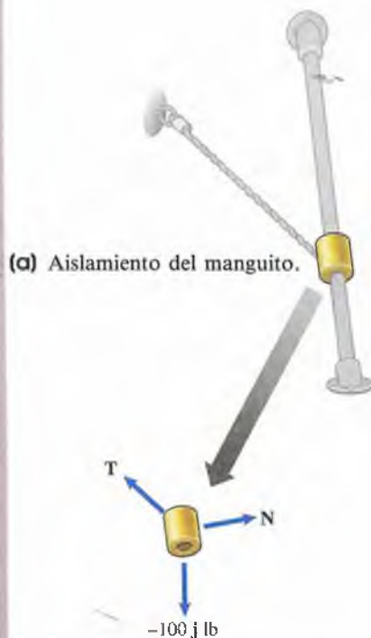
(b) Diagrama de cuerpo libre del manguito con las fuerzas ejercidas por su peso, el cable y la barra.
