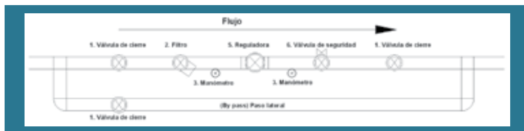
Figura B. 6.2 Esquema general de la estación reguladora
