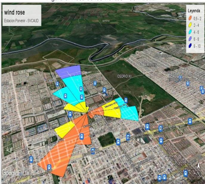
Figura 9: Grafica polar PM<sub>10</sub>, en relación con la velocidad y dirección de viento.
