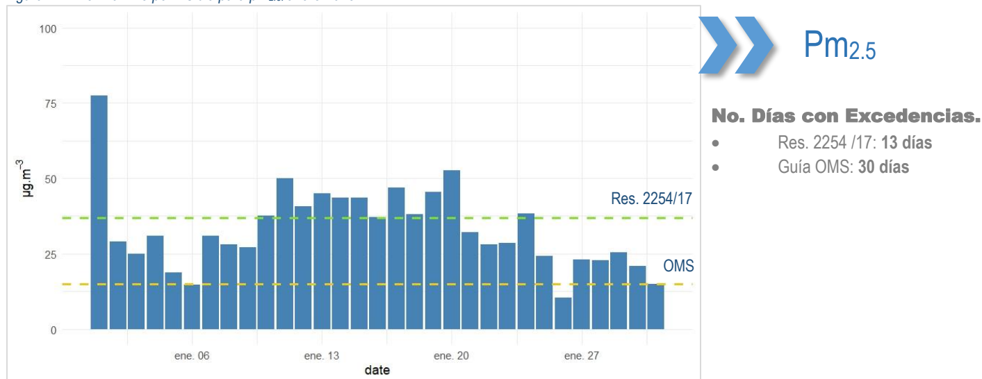
Figura 4. Nivel máximo permisible para pm_{2.5} . enero 2025.
