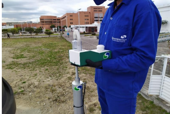
Figura 2: Verificacion y Calibracion de Flujo4
