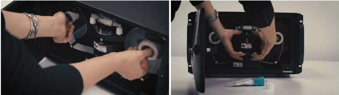
Figura 7: Procedimiento para cambiar la cinta filtro.
