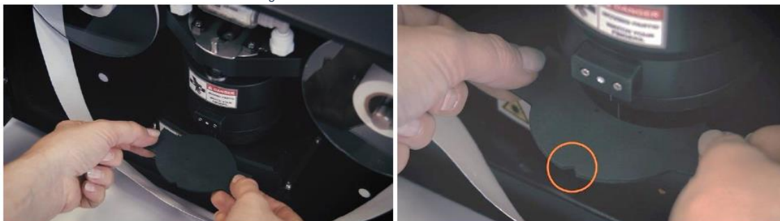
Figura 9: Instalación de Almohadilla.
