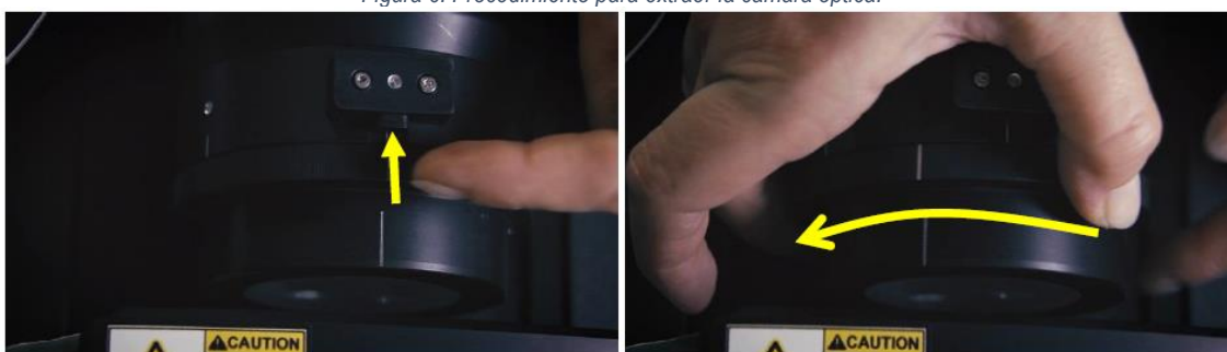
Figura 6: Procedimiento para extraer la cámara óptica.
