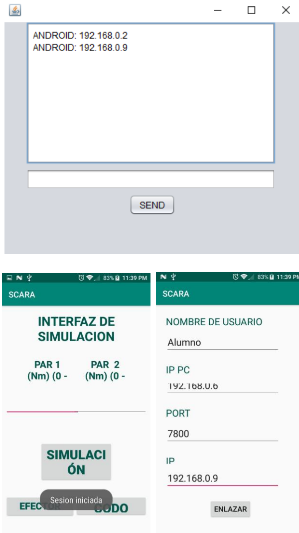
Figura 8: Conexión de un segundo dispositivo móvil al servidor y almacenamiento de su IP.
