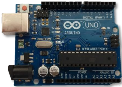
Figura 1: Placa de microcontrolador Arduino UNO
