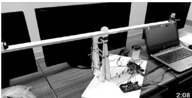
Figura 4. Ball beam system- IPN ESIME Tic (Dic. 2017 YouTube). (Fuente: Realizada por alumnos con asesoría por Autor).
