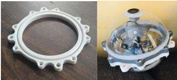
Figura 6. Anillo impreso en PLA, Prototipo de flotador
