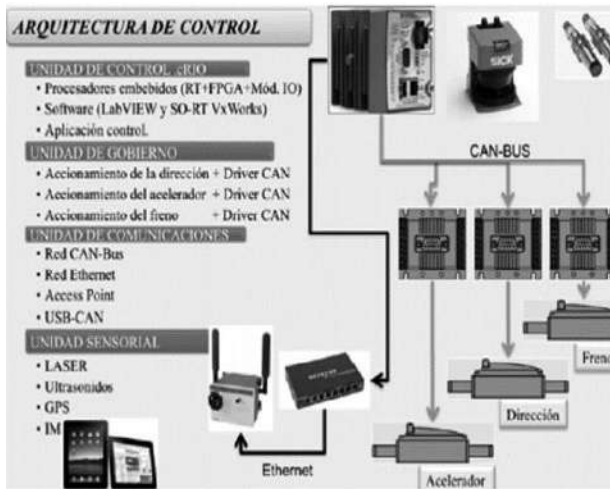
Figura No. 3: Arquitectura de control
