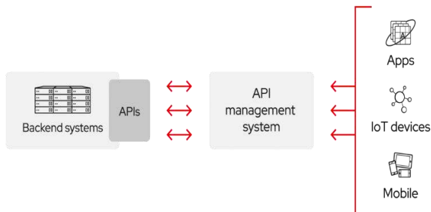
Figura No. 7. Esquema de funcionamiento de las APIs
