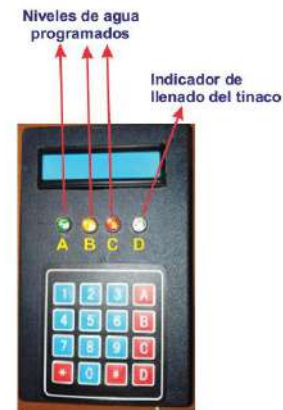
Figura 3. Pantalla LCD con indicadores de nivel. Elaboración propia.
