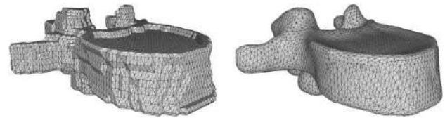
(a) Superficie sin suavizado (b) Suavizado del 50%
