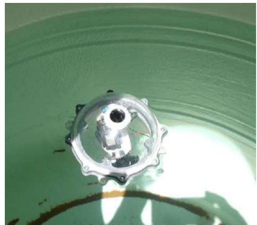
Figura 7. Sistema flotador en interior de tinaco. Prototipo de flotador
