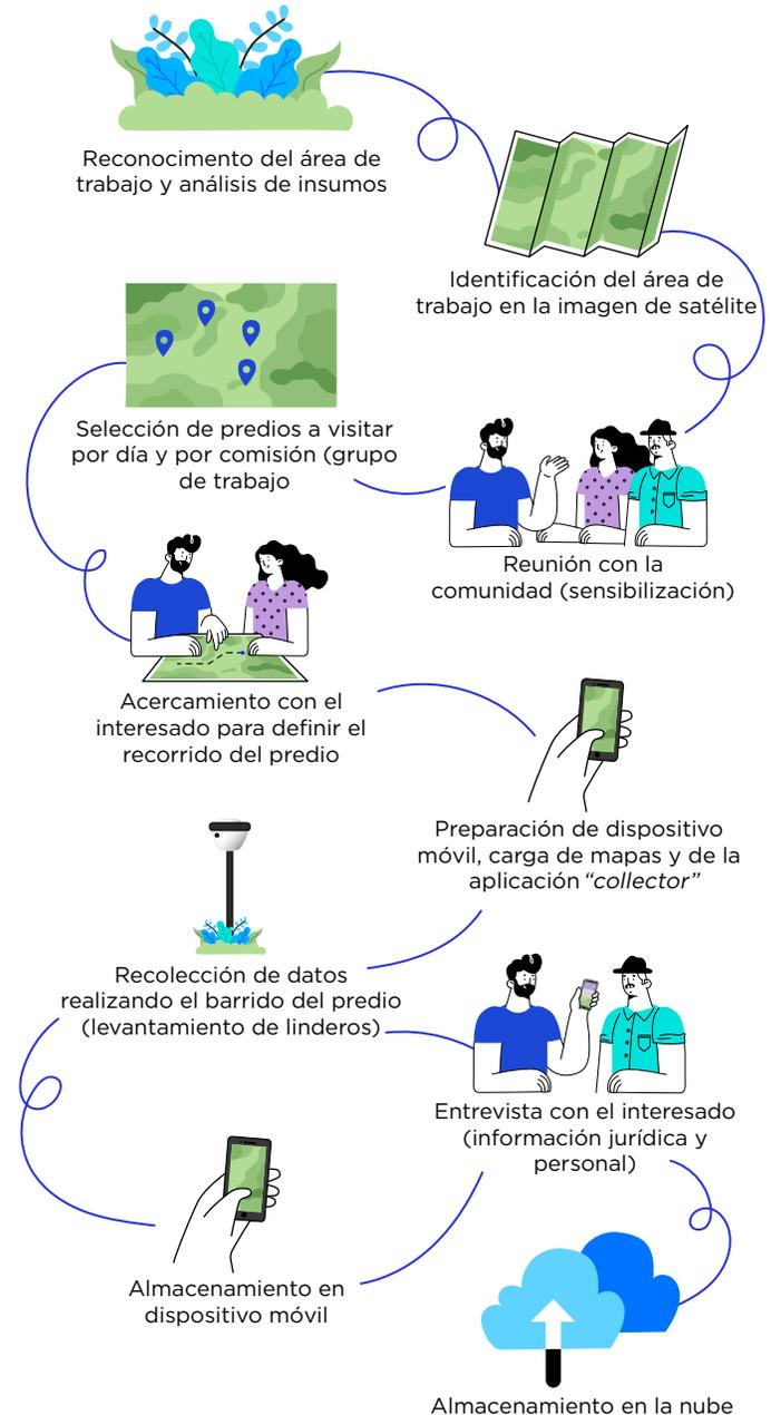
Figura 1: Diagrama de flujo de la adquisición de datos en campo aplicando la metodología FFP
