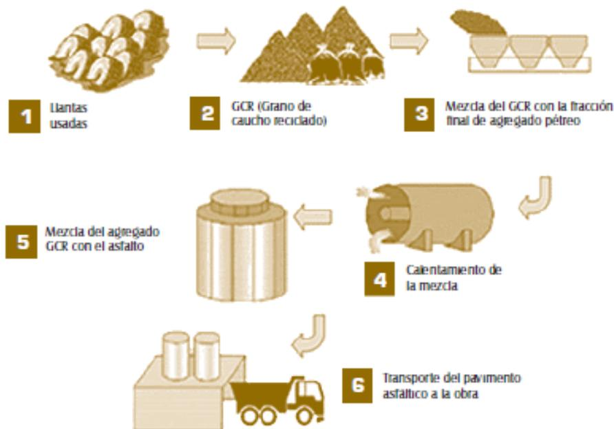
**Figura 4.** Proceso para la obtención de pavimento modificado convencional.
